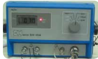
Encima: aparato DH polarográfico ("hidrógeno disuelto) de la Empresa TOA-DKK. Ese aparato también es certificado por la investigación del agua electrolizada
